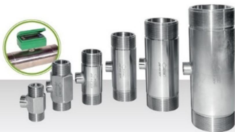
Contaltri standard filettato, in acciaio inox AISI 316, conforme al contatto con alimenti. Disponibile nelle misure da 3/4" a 3" con display digitale opzionale Pony flow 9 e 12 volt.
